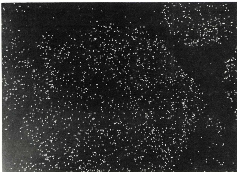
Figura 5. Mapping d'Ag de la figura 3.
