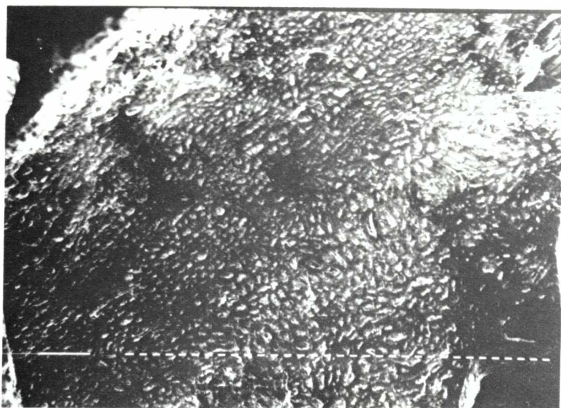
Figura 7. Imatge SEM per electrons secundaris d'un carbó vegetal impregnat amb 0,049 % de \text{AgNO}_3 . Marques: 10\mu\text{m} ( \times 160 ).
